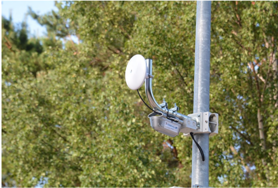
9. attēls. Automatizēta pastāvīga skaitīšanas ierīce stacionārā punktā pie gājēju laipas uz jūru ar videokameras tiešsaistes režīmu un automatizētu datu pārraidi un apkopošanu.
