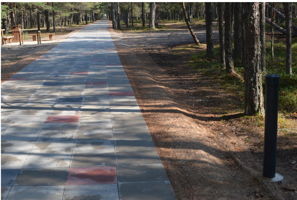
6. attēls. Automatizēta pastāvīga skaitīšanas ierīce stacionārā punktā pie gājēju un velosipēdistu ceļa ar nodrošinātu tiešsaistes datu pārraidi.
