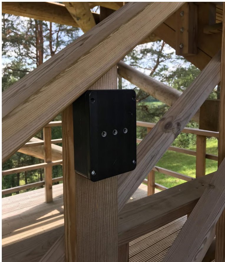
10. attēls. Automatizēta pastāvīga skaitīšanas ierīce stacionārā punktā skatu tornī, izmantojot infrasarkanā sensora mērierīci un datu manuālu nolasīšanu.
